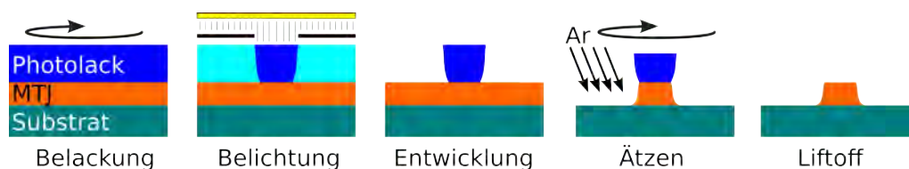
Abbildung 3.5.: Optische Strukturierung unter Verwendung von Negativlack.
