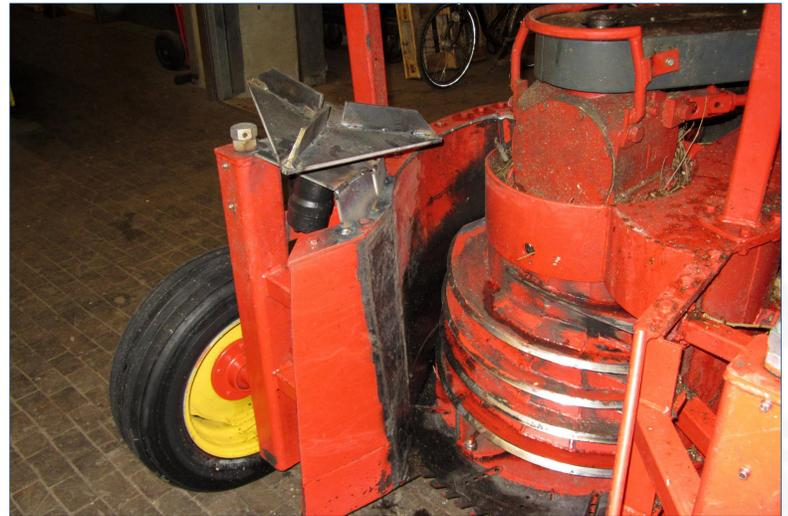
Abb.2: Gehölmähhäcksler mit Zuführeinrichtung, vergrößerter Zuführung und optimierten Schneckengängen.
