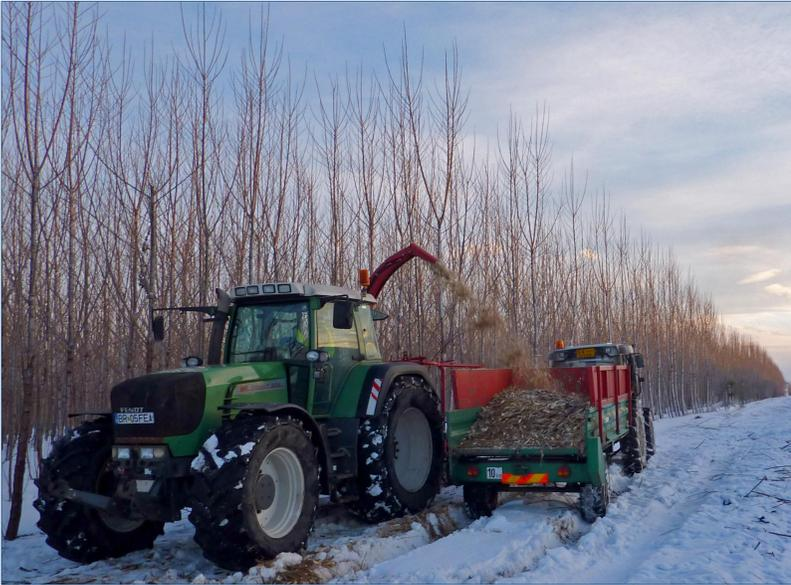
Abb.1: Einsatz des aktuellen Prototyp im 4-jährigen Pappelbestand (Durchmesser durchschnittlich 14,5cm).
