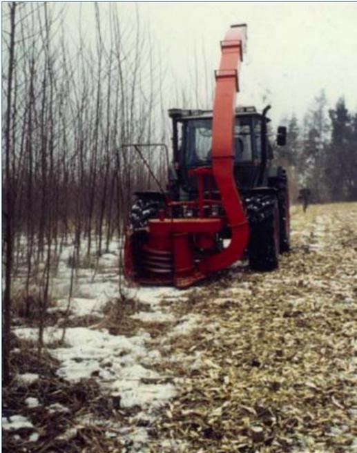
Abb.1: Erster Prototyp des Gehölmähhäckslers ohne Beschleuniger für Hackgut Ende der 90er Jahre.
