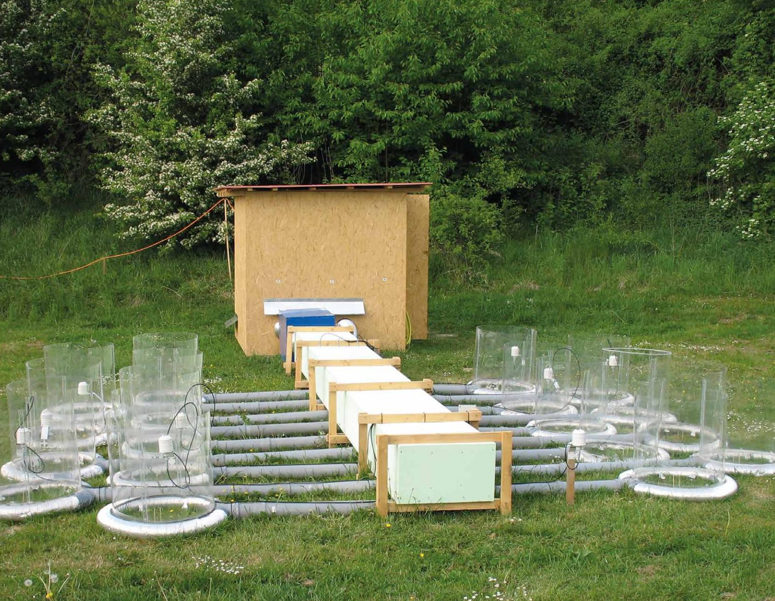
Experimentieranlage zur Manipulation der Luftfeuchte mit 16 »Open-Top-Kammern«
