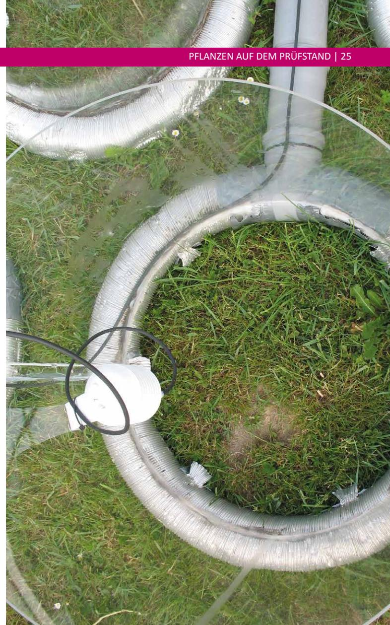
Blick von oben in eine Open-Top-Kammer der Luftfeuchte-Experimentanlage im Grasland
