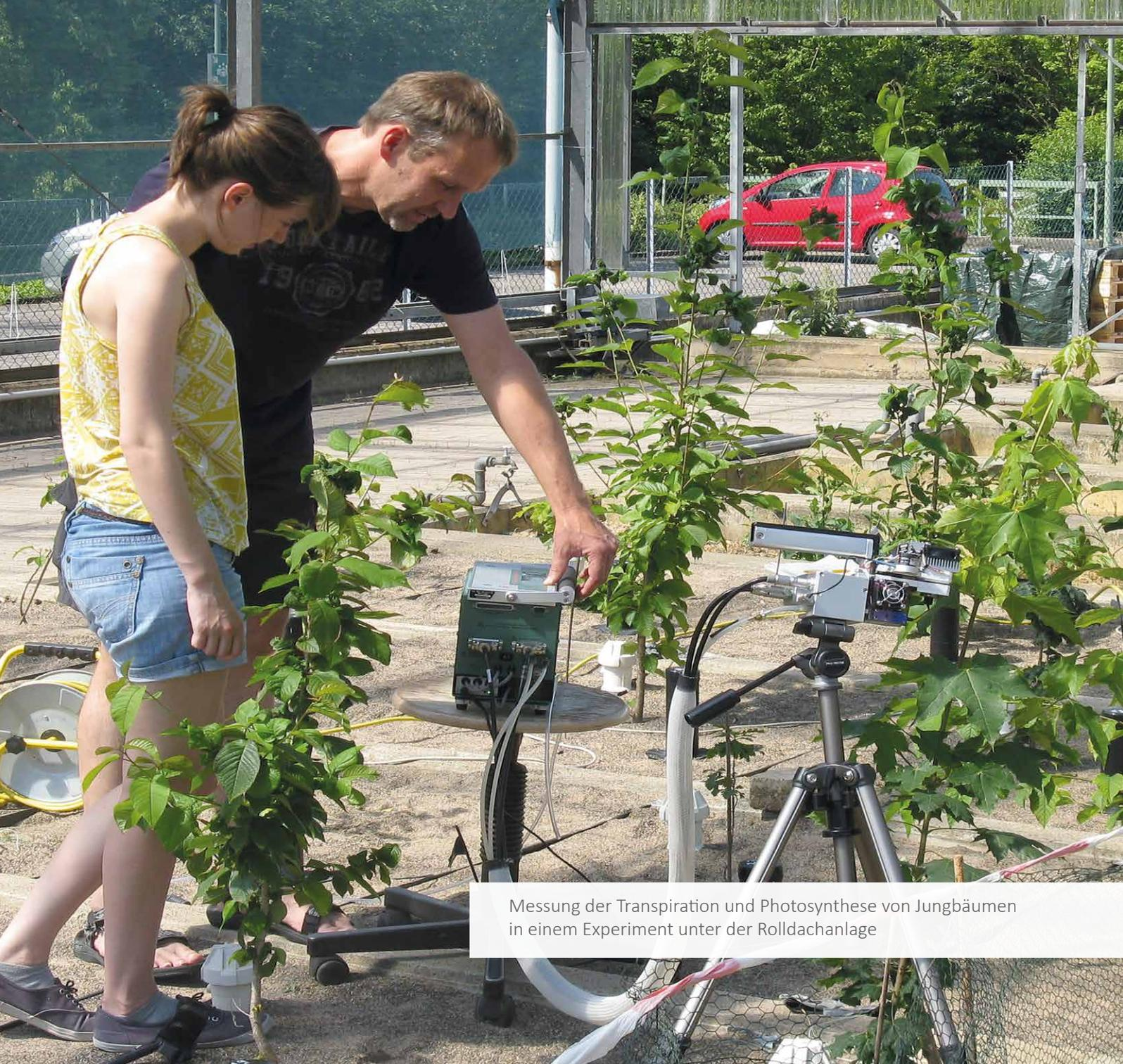
Messung der Transpiration und Photosynthese von Jungbäumen in einem Experiment unter der Rolldachanlage
